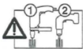
Préferez avant vissage Drill before screw
