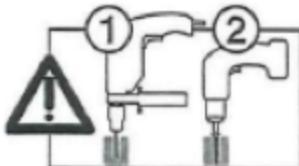
Préforez avant vissage Drill before screw
