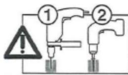
Préforez avant vissage Drill before screw
