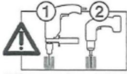
Préforez avant vissage Drill before screw
