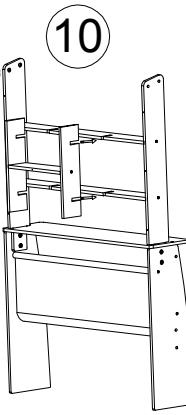
Wanneer je paneel X bevestigt, begin dan met de 7 centrale vijzen, maar draai ze niet volledig vast. Neem vervolgens de 6 buitenste vijzen en draai deze wel vast. Daarna kan je de 7 centrale vijzen vastzetten.
