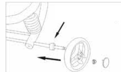
2. Faites passer l'axe dans les trous de la partie arrière du châssis et placez ensuite un anneau en plastique, une roue, un clip et un cache de roue.
