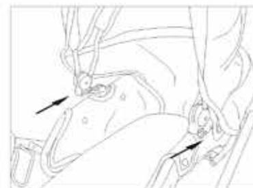
5. Insérez d'abord les connecteurs de la capote pare-soleil dans les trous prévus dans le tissu du siège. Fixez ensuite la capote à la poignée, en veillant à ce que les éléments coulissants soient au même niveau que les boutons poussoirs.
