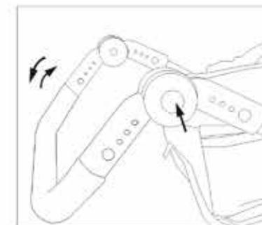
6. Stel de duwstang in op de gewenste hoogte, door de knoppen op de zijkanten van de duwstang gelijktijdig in te duwen en tegelijkertijd de duwstang naar boven of onder te bewegen.
