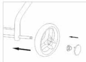
1. Faites passer l'axe dans les trous de la partie avant du châssis et placez ensuite une roue, un clip et un cache de roue.
