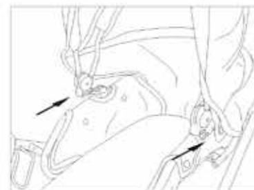
5. Bevestig eerst de pinnen van de kap in de daarvoor voorziene gaatjes in de bekleding. Maak nadien de kap aan de duwstang vast, met de banden op dezelfde hoogte van de drukknoepen.
