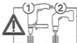
Préforez avant vissage Drill before screw
