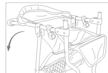
5. Replier la poussette : tirez le verrou vers le haut jusqu'à ce qu'il se détache du haut du tube avant.
