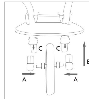
3. A. Insérez l'axe avant dans la roue avant, puis placez les petits anneaux et enfin les fixations sur l'axe.
