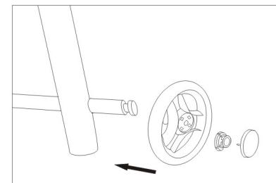
4. Assembler les roues arrière : sortez les roues et les accessoires de l'emballage avec les pièces de rechange, insérez l'axe dans le cadre, ensuite la roue, le clip et le cache de la roue.
